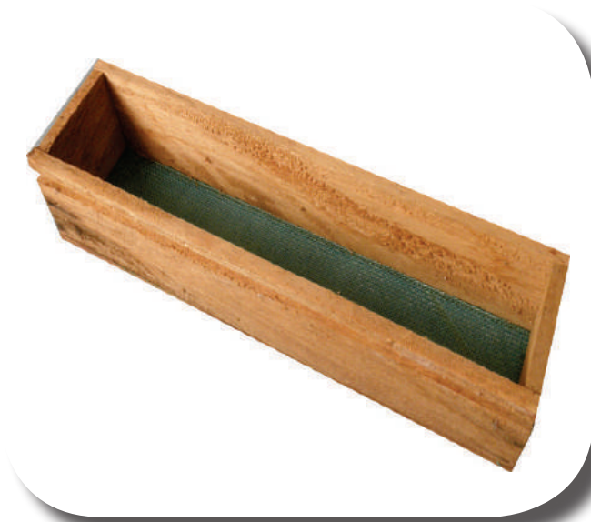
Fotografía 11: Cajón de acumulación de la trampa
