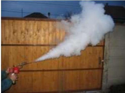
Si nous considérons plus en détail le travail de Varamor, nous pouvons distinguer plusieurs étapes de base de son fonctionnement. La préparation pour le traitement est introduite dans un tube qui, dans une certaine zone, a la forme d'une spirale. Cet endroit est chauffé avec du gaz dans un ballon à une température à laquelle la vapeur quitte le tube.
