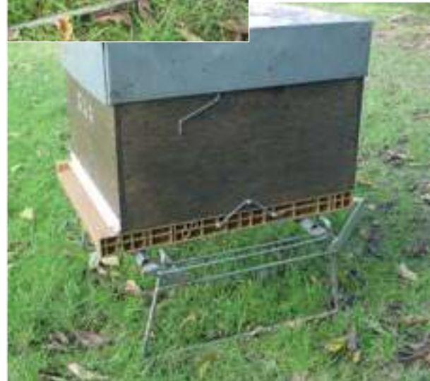
Un manche équipé d'un dynamomètre s'emboîte sur le levier soudé à la partie mobile du support. Lorsqu'on soulève la ruche, le dynamomètre donne une évaluation du poids.
