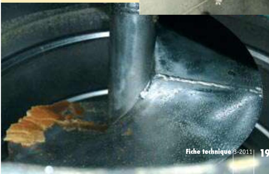
Il faut éviter les rotations trop rapides ou l'inclusion d'air possible lorsque les barres sont trop proches de la surface du miel (quelques centimètres).
