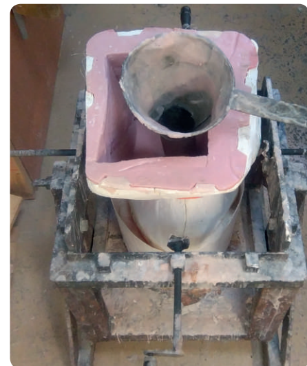
Le moule est placé dans le châssis, tête en bas
