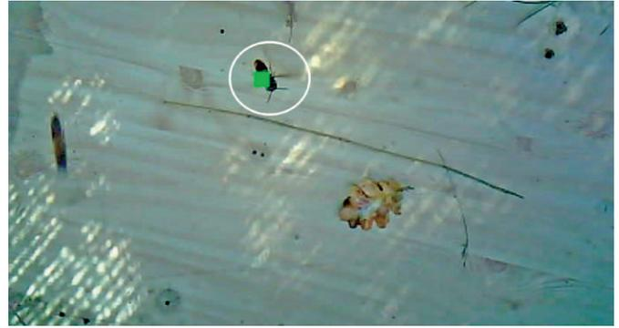
Photo 4.b : L'algorithme a détecté le frelon en vol stationnaire en marquant d'un carré vert et en négligeant les autres éléments.
