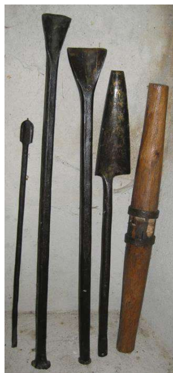
Figure 36 – Quelques outils utilisés pour creuser les troncs : gouges, emporte-pièces et manche de tarière. (Photo : A. Lehébel-Péron)
